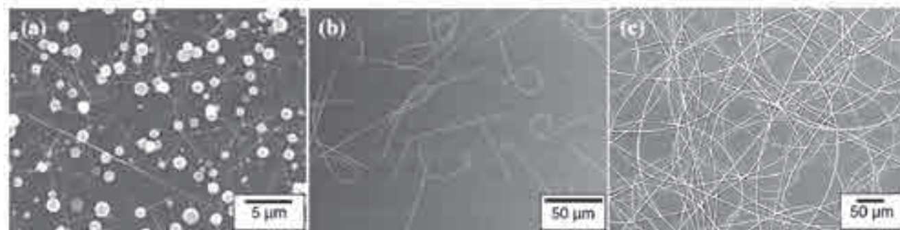
شکل ۱- الیاف الکتروریسی شده از محلول پلیمری با غلظت‌های مختلف: (a) ۹ wt%، (b) ۱۳ wt%، (c) ۱۸ wt%، ولتاژ ۴/۴ کیلوولت و نرخ جریان محلول پلیمری ۰/۳ میکرولیتر بر دقیقه بود.
