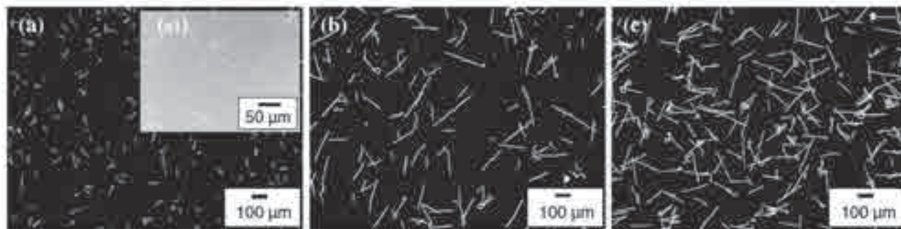
شکل ۲- عکس‌های میکروسکوپی نوری الیاف کوتاه تولیدشده از محلول‌های پلیمری با غلظت‌های مختلف: (a) ۱۳، (b) ۱۴ و (c) ۱۵ درصد وزنی. ولتاژ ۵/۵ کیلوولت، و نرخ جریان ۰/۱ میکرولیتر بر دقیقه بود.
